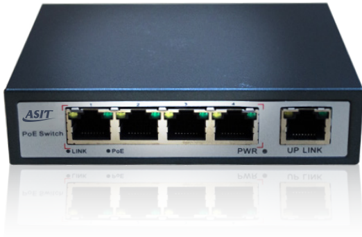
PoE Layer2 Switch (OSI Model)
